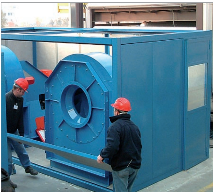
Cabine insonorisée pour ventilateurs (avec suppression du bruit de 90 dB à 65 dB)
