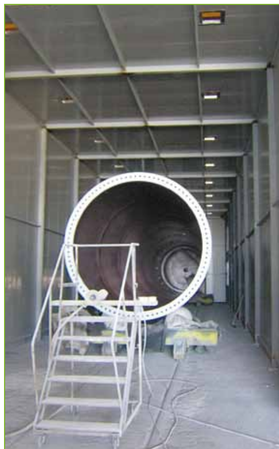
Cabina di sabbiatura torri eoliche
